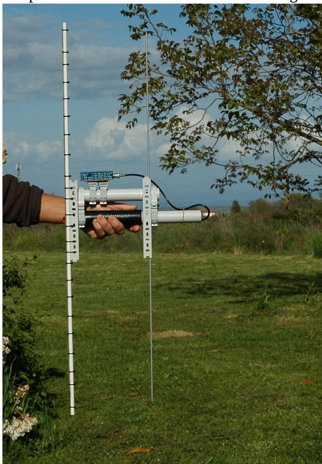
La mia 2 elementi yagi da radiocaccia sui 2 m, con dipolo ripiegato realizzato tramite una piattina bifilare da  $300\Omega$ .
