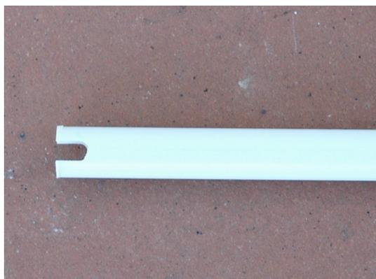
Fig.8 Cocca per l'ancoraggio del filo elettrico.
