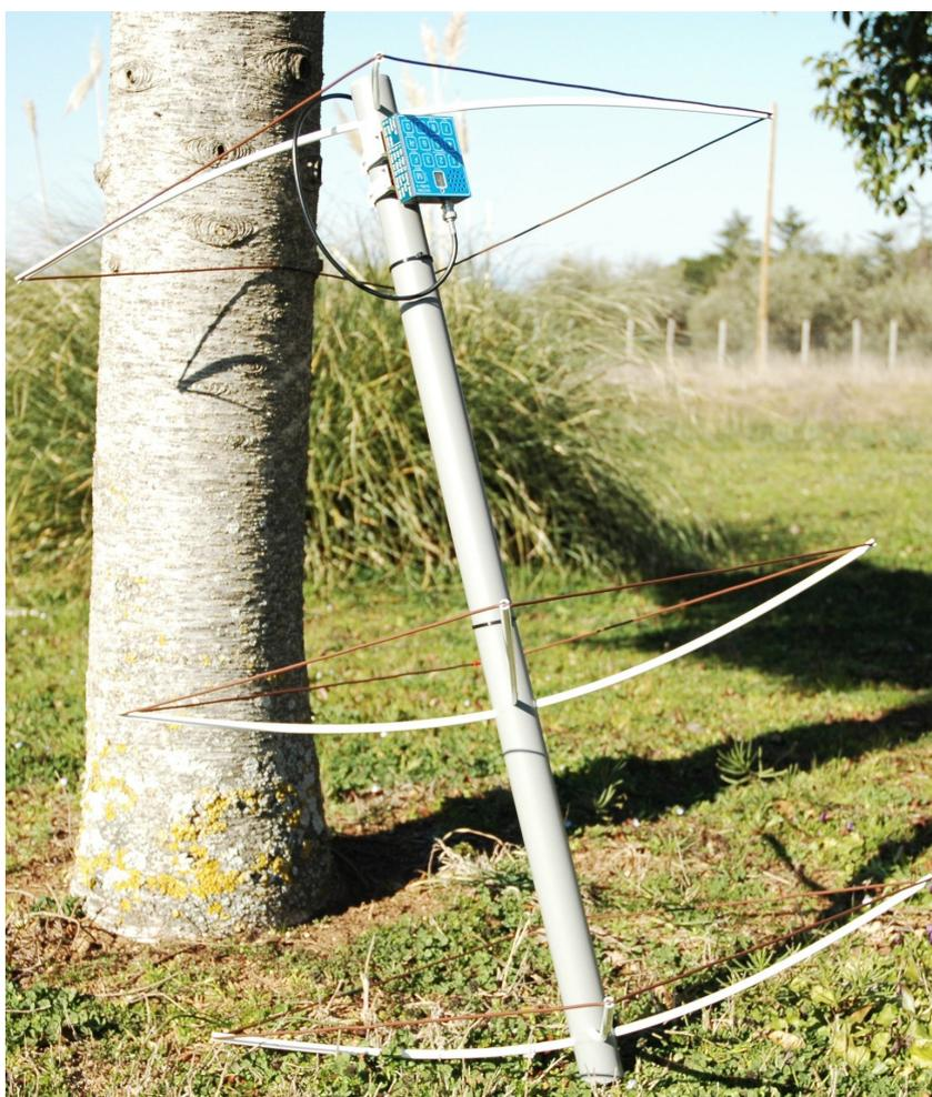
Fig.1 - 3 elementi Quad per ARDF di IKØDWJ, pronta per l'uso.
