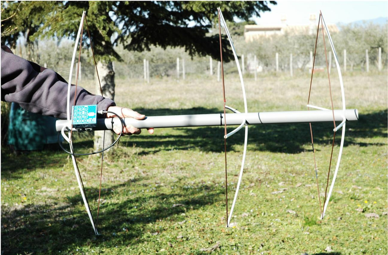
Fig.3 - La 3 elementi Quad con sniffer di IKØDWJ in azione.
